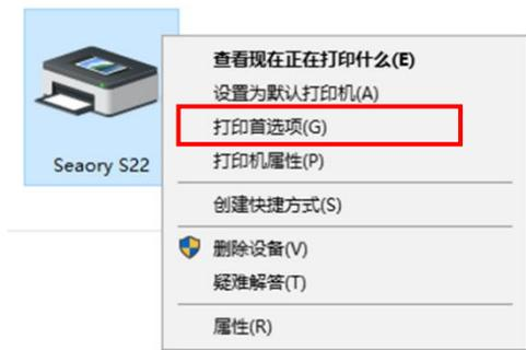
① 在“设备和打印机”右键点击“Seatory S22”名称的打印机，选择“打印首选项”。
