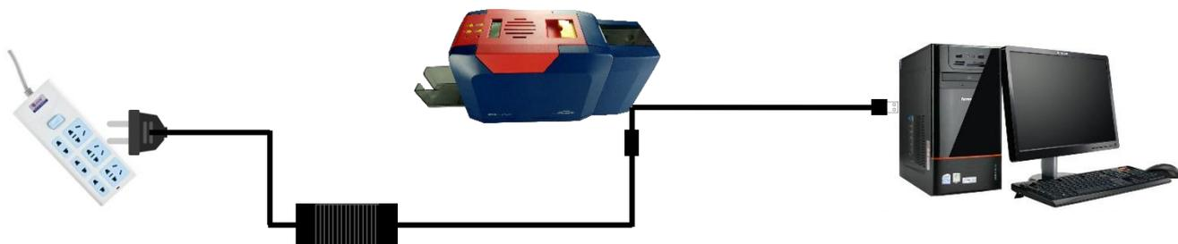
① 电源适配器 24V 接头插入证卡机电源接口，电源线与适配器连接好，再把电源线插入市电插座。但先不要通电，驱动安装步骤完成后再通电。
